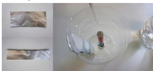
Εικ. 9: Διαμόρφωση λωρίδας αλουμινόχαρτου και στήριξη της στο πλάι του δοχείου με το μαγνήτη, που αργότερα ρίχνουμε και το αλατόνερο.
